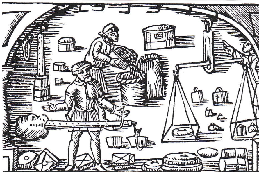
Mätning och vägning under Vasatiden enligt Olaus Magnus "Historia om de nordiska folken". Till vänster vägning av tackjärn med besman och till höger med likarmad våg. I bakgrunden uppmätning av spannmål.
