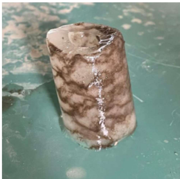
Figur 2. Material precis efter infrysning med tydlig separation mellan (frost) vatten och soliden.
