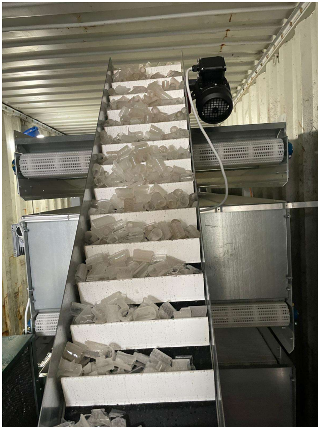
Figur 5. Materialet transporteras ut från infrysningsenheten (plundring).
