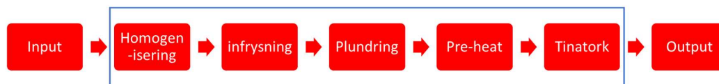
Figur 3. Schematisk skiss av processteg i frysavvattningsanläggningen. Blå rektangel markerar steg som är integrerade i container.
