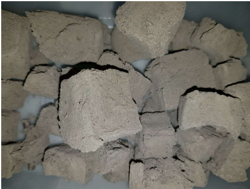
Figur 8. Residual efter frysavvattning.
